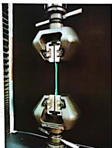
图4 拉伸强度（纵向）试验及曲线 Fig.4 Tensile strength(MD) test and curve
